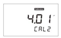
3.3 用蒸馏水清洗 pH 电极并浸入 pH4.01 标准缓冲液中,缓慢搅拌。
