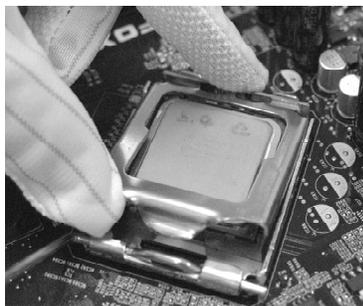
6. 将承载杆向下压，使其紧闭。然后用承载盘旁的钩子固定承载杆。至此CPU 已完全被固定好。
