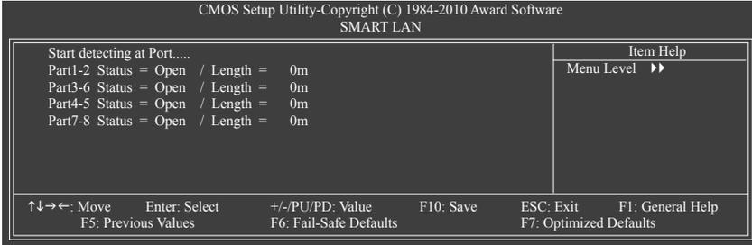
이 메인보드에는 연결된 LAN 케이블의 상태를 감지하도록 고안된 케이블 진단 기능이 포함되어 있습니다. 이 기능은 케이블 배선 문제를 감지하고 장애나 단락까지의 대략의 거리를 보고합니다.
