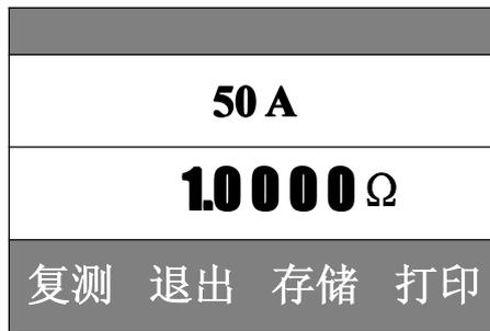
上图为液晶显示器和键盘组件组成的显示控制部分，其中显示器为点阵式液晶显示屏，用于显示操作提示、测量结果、以及指示显示屏下部 4 个多功能按键的用途。左侧的“Return”键可使仪器在出现死机或从菜单退出时直接返回到初始状态。最右侧的小孔为显示器对比度调节孔，在显示器出现显示图形对比度过深或过浅，影响阅读效果时，可以用小型“一”字改锥进行适当调节。
