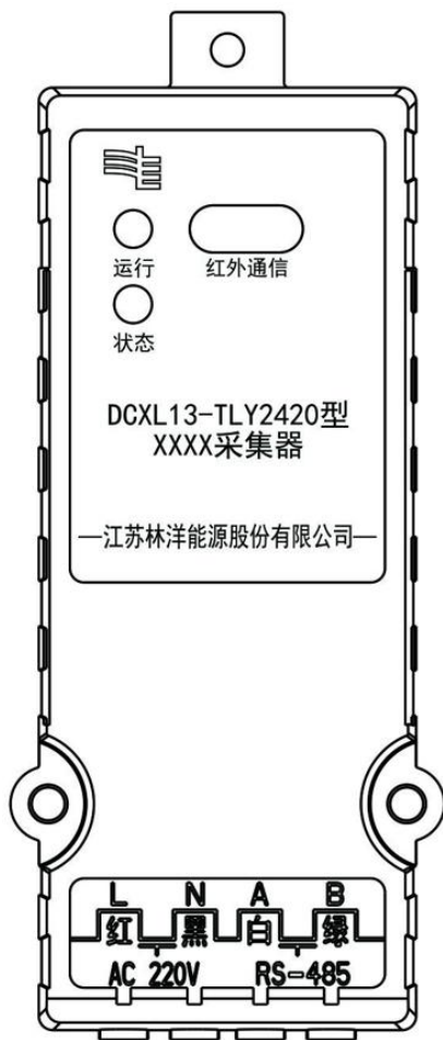
图 1 采集器外观结构示意图
