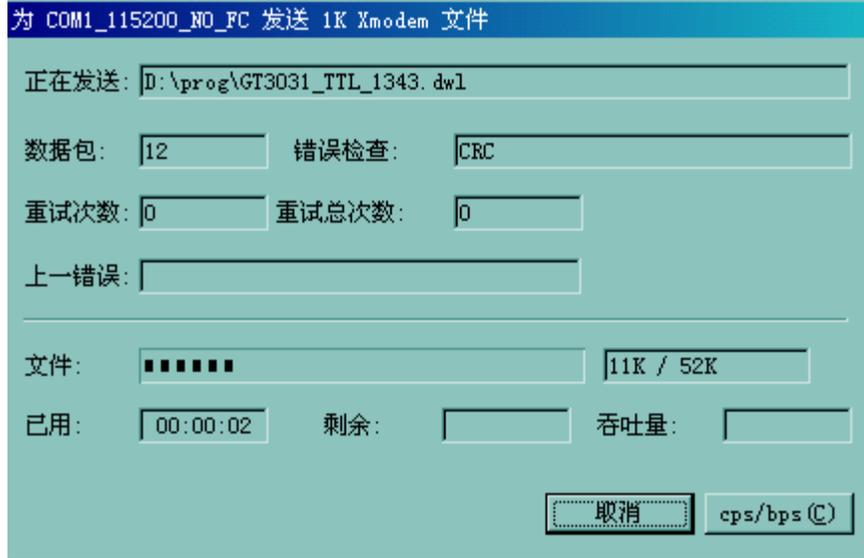
(4) 下载完成后，还需要等待2分钟左右才能完成软件升级。在此期间，超级终端会不断输出提示字符。软件升级完成后，CT3031-DC会自动复位。
