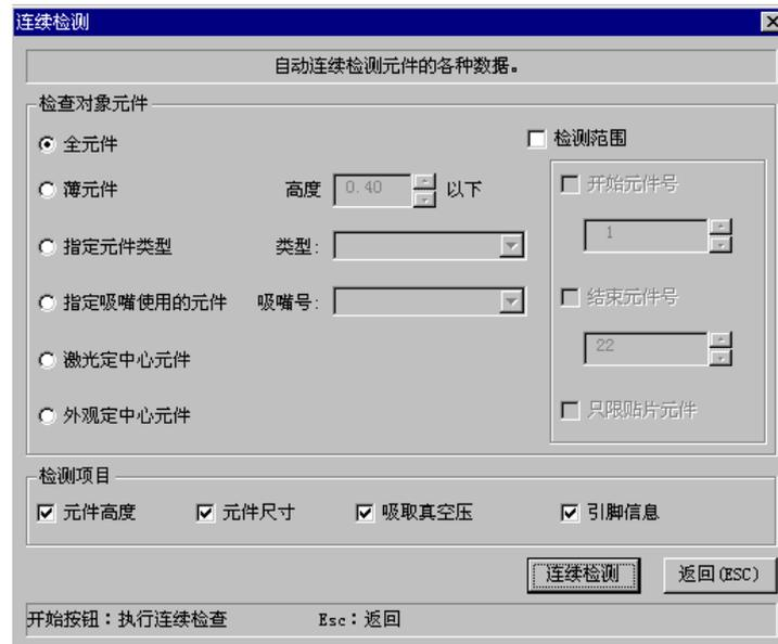
图 4-5- 29 连续检测条件的设定
