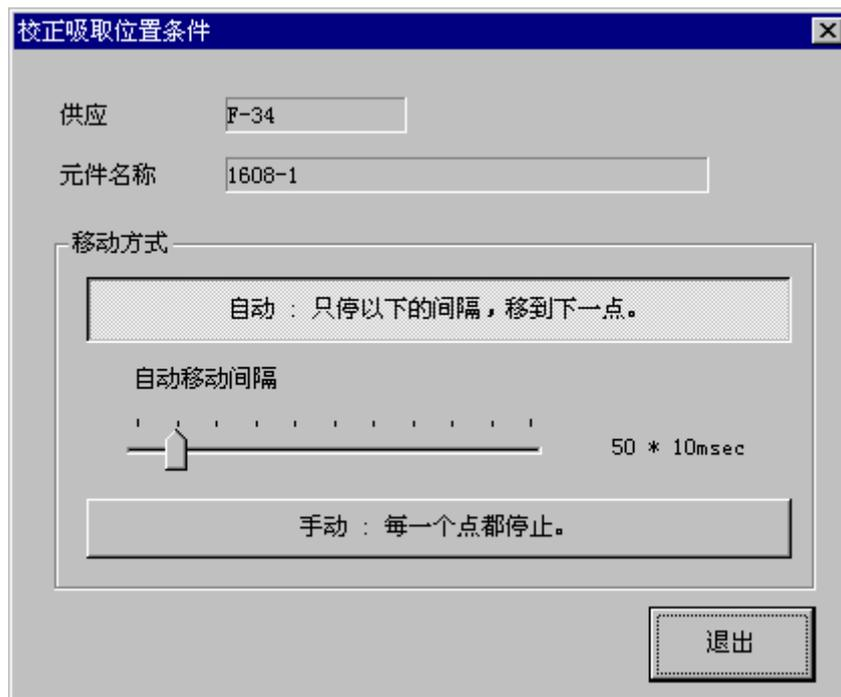
图 2- 48吸取位置校正条件设定对话框
