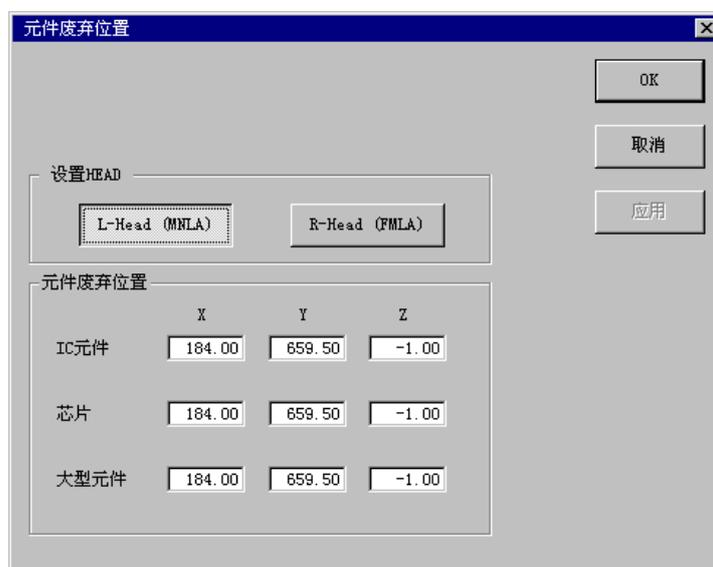
图 5- 23元件废弃位置的设置 (KE-2060)
