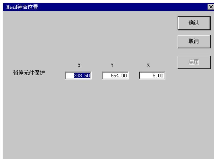
图 5- 25贴片头待命位置的设置对话框
