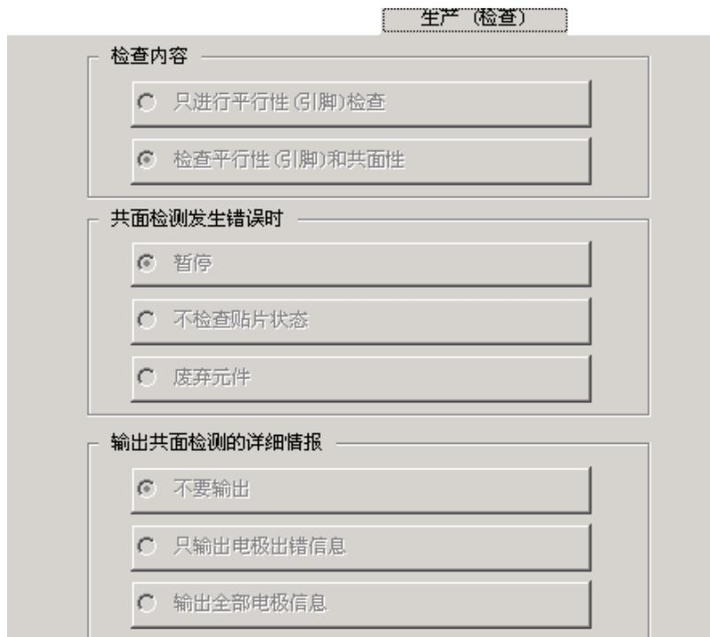
图 5- 9 生产时的检查选项 (显示例, KE-2060)
