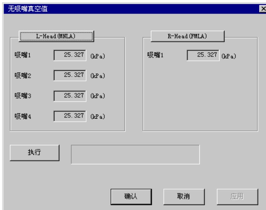
图 5- 18 无吸嘴的真空值设置 (显示例. KE-2060)
