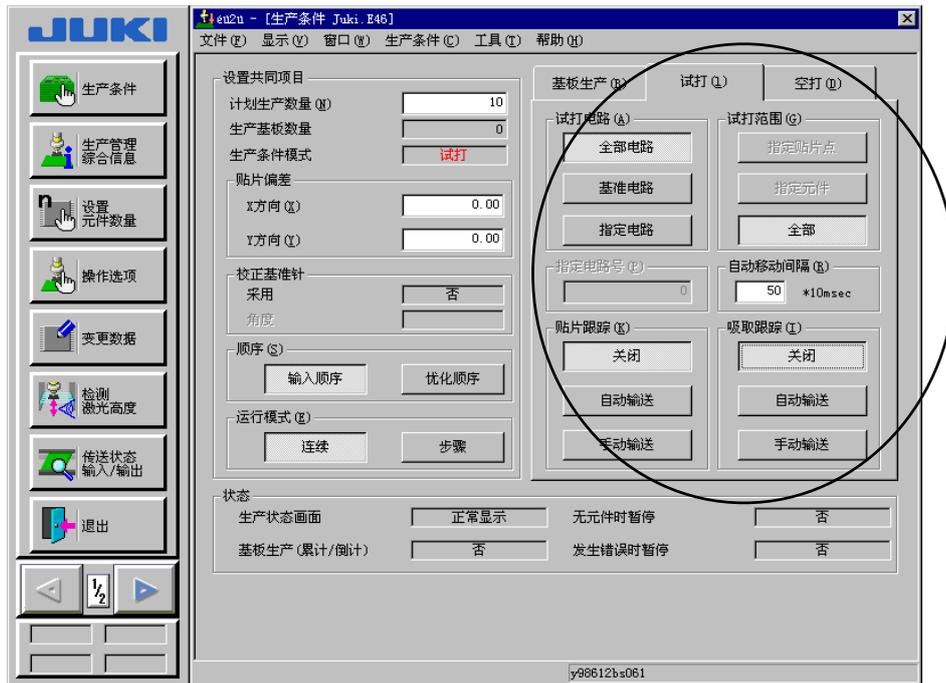
图 2- 22试打条件的设定
