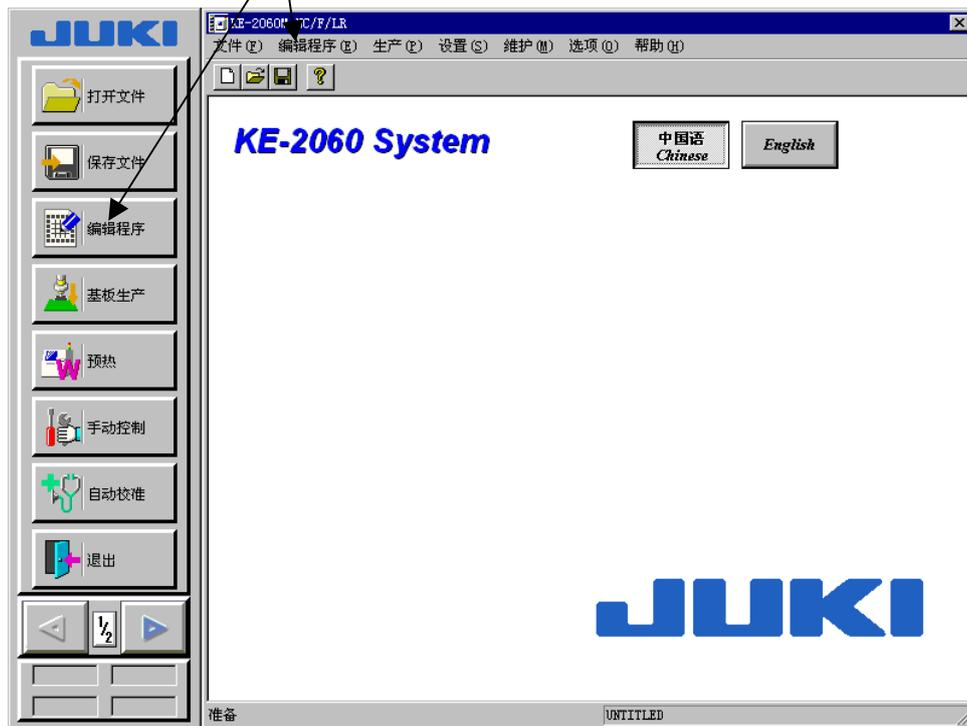
图 4-3-1 编辑程序的启动
