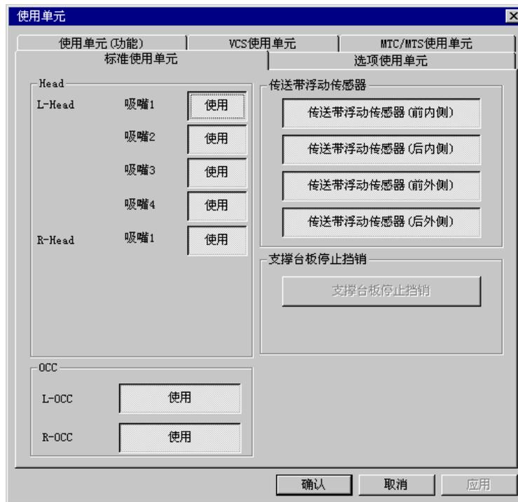
图 5- 26使用单元设置画面(显示例. KE-2060)
