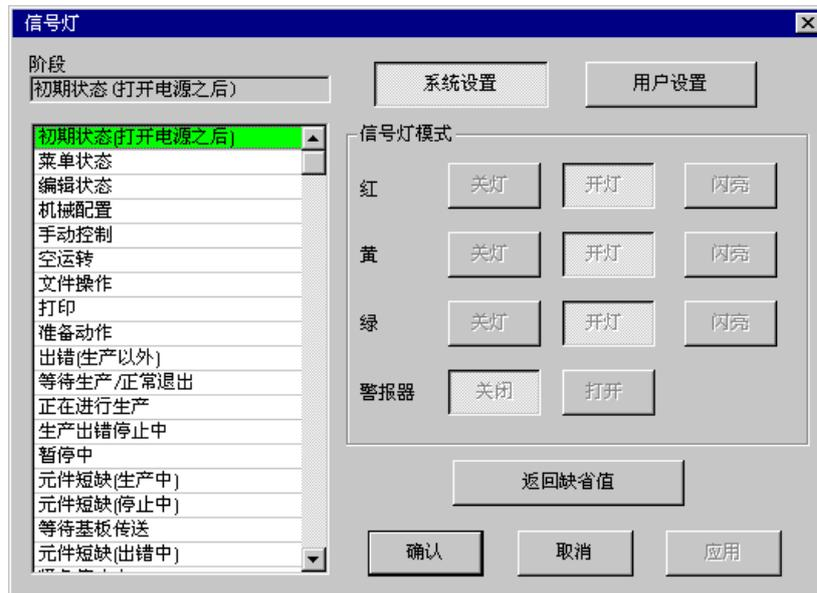
图 5- 34信号灯设置的对话框画面
