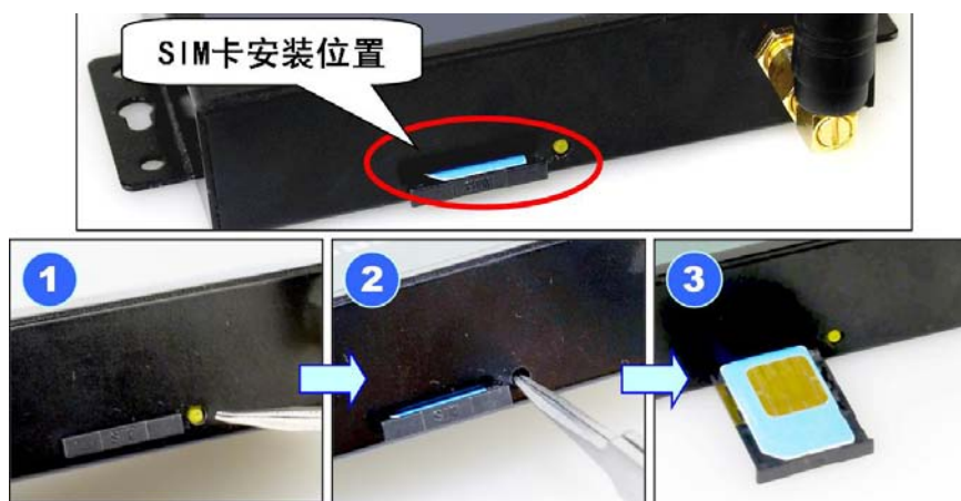
图 2.2 SIM 卡的安装
