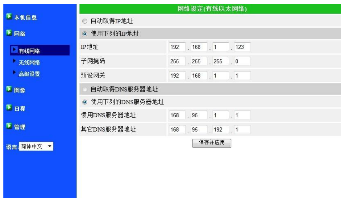
图 3-6: 网络设置中的固定 IP 地址
