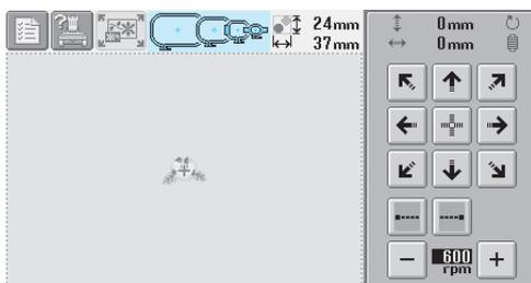
Les cadres de broderie pouvant être utilisés sont plus sombres (☐+), ceux ne pouvant pas être utilisés sont plus clairs (☐+).
