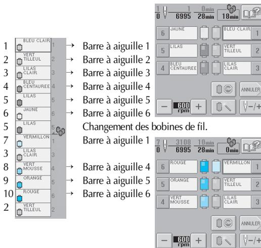
Les couleurs de fil des barres à aiguilles 2 et 3 devant être réutilisées après le changement des bobines de fil, elles ne sont pas remplacées. Toutefois, différentes couleurs sont attribuées aux autres barres à aiguilles.
