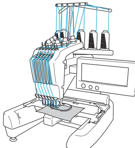
Vous ne pouvez pas utiliser simultanément les six aiguilles pour coudre. Une seule aiguille à la fois est placée en position de broderie. En fonction de l'ordre de couture, le boîtier de barres à aiguilles est déplacé vers la gauche et la droite de façon à placer la barre à aiguille et le fil de l'aiguille de la couleur requise en position de broderie.
