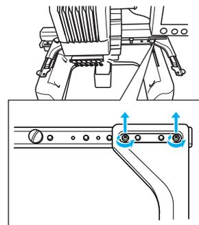
**5** Retirez le bras droit, alignez les ergots du support du cadre de broderie sur les trous du bras, comme illustré, puis insérez les vis retirées à l'étape 1 et serrez-les.
