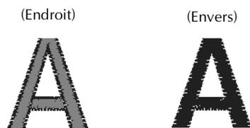
Si la tension du fil supérieur est trop élevée, le fil de dessous est visible sur l'endroit du tissu.
