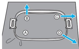
Alignez tout d'abord les cadres intérieur et extérieur au niveau du coin avec la vis (A). Puis, tout en tirant légèrement le tissu dans le sens indiqué par la flèche B pour le tendre, insérez le cadre intérieur par le coin B. De même, tirez légèrement le tissu dans le sens indiqué par la flèche C et insérez le cadre par le coin C, puis tirez légèrement le tissu dans le
