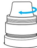
Augmentez la tension en tournant le bouton correspondant dans le sens des aiguilles d'une montre.
