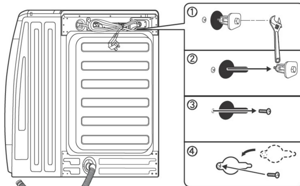
拆除掉的运输用固定螺栓，在搬
