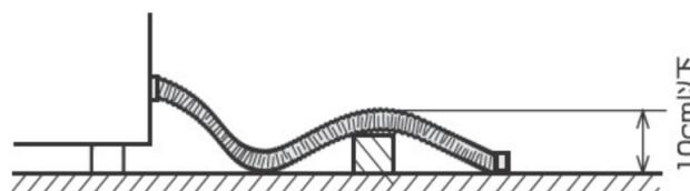
●要延长排水管时其长度应在3m以下。排水管中端不可抬高。
