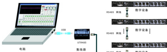
图1 连接电脑的方法
