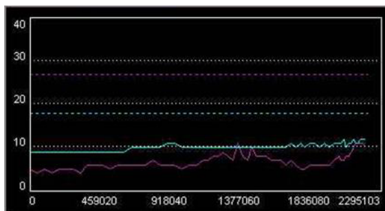
优质盘片: 低于标准值且平稳的 TE/FE 线图
