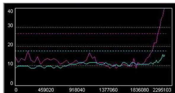
品质不佳的盘片: TE/FE 高于标准值且线图起伏大
