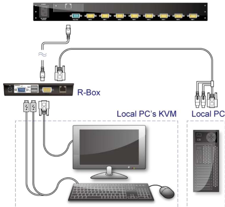
**Figure 4-11. CAT5 Module Installation**
