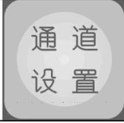
通<br>道<br>设<br>置 | 设置 DM 输入通道的模式选择、信号类型、开启角度、关闭角度、输出选择、间隔周期、延迟时间。 <b>需要密码才能进入通道设置页面。</b> |
