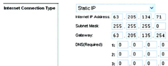
图 6-4: 静态 IP 连接类型
