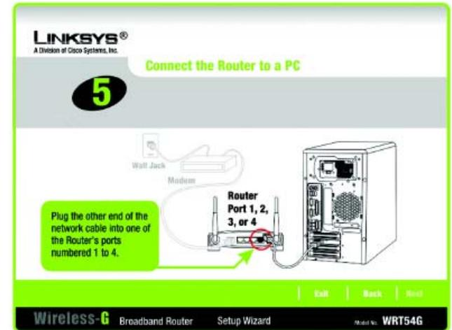
图 5-7：安装向导的连接网线到路由器上的界面
