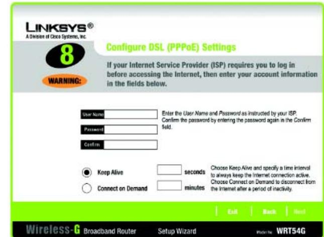
图 5-11: 安装向导的配置 DSL (PPPoE) 设置界面
