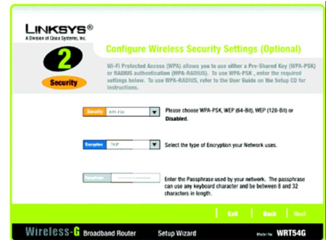
图 5-29：安装向导的无线安全—WPA-PSK 界面
