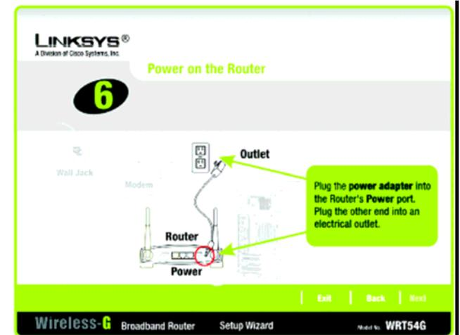
图 5-8：安装向导的给路由器上电的界面
