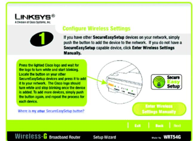
图 5-18: 安装向导的配置无线设置界面
