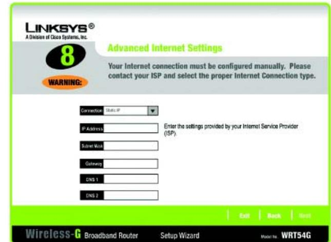
图 5-12: 安装向导的高级互联网设置-静态 IP 界面
