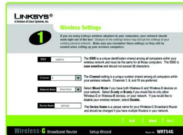
图 5-28：安装向导的无线设置界面
