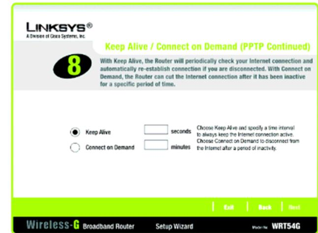
图 5-14: 安装向导的保持活动/根据要求进行连接（PPTP 续）界面
