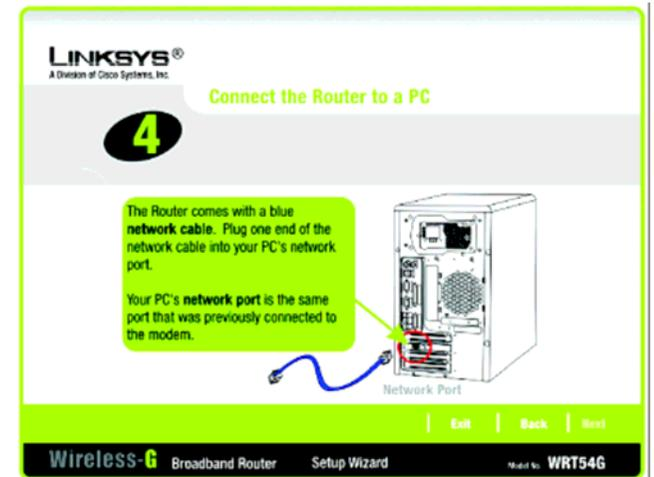
图 5-6：安装向导的连接网线到电脑上的界面
