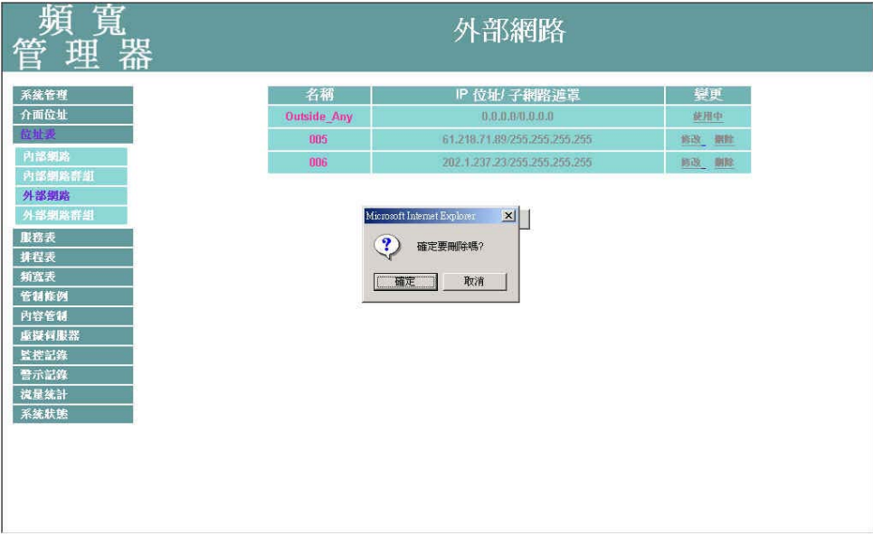
圖 3-12 移除外部網路位址
