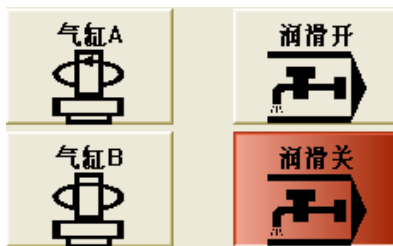
图 5- 5 操作面板上气缸阀门、润滑阀门启停按钮图
