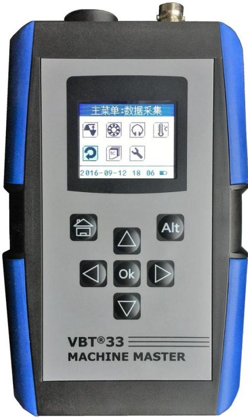
VBT33 机器状态巡检仪是一个手持式、多功能、低成本的机器状态评价工具和数据采集器，用于测量、评价和记录旋转机器的振动和轴承状态，结合 VBT-View 机器状态管理软件，对机器状态进行趋势监测、报警和报告。其操作简单易用，适合于工厂一线生产人员，设备点检和维护人员使用。
