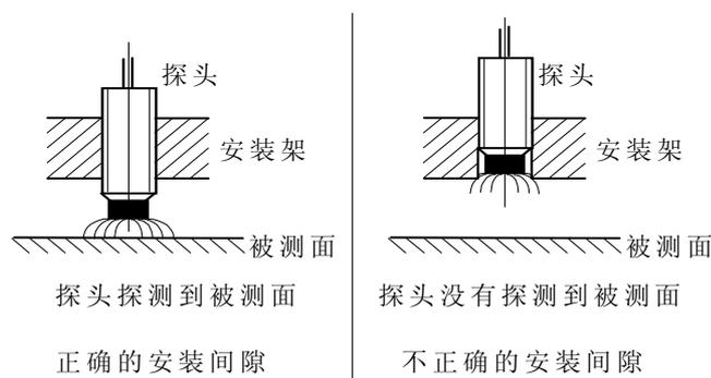
12、将探头旋进螺纹安装孔时，用力不能过猛，否则可能压坏探头和被测体。将探头旋进螺纹安装孔时，必须同时转动探头所带的电缆，否则有可能将电缆扭断，如果带有延伸电缆，应将延伸电缆取下。
