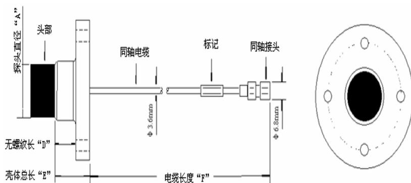
☆ 除非采用机器外部安装支架安装探头或者安装空间限制，通常选择标准安装类型的探头。
