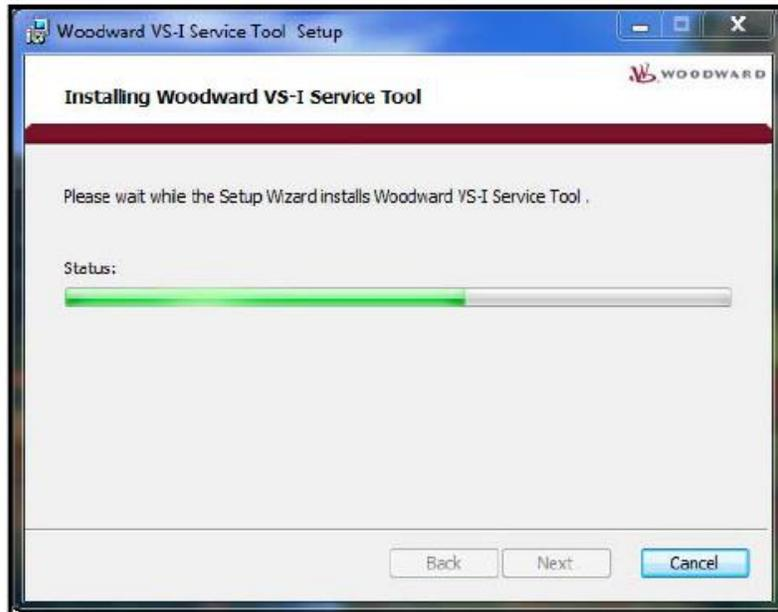
6. 当安装结束后，会出现安装完成画面。左下角“Launch when setup exits”对话框是默认不选中的。即在 VS-I 已经连接到电脑串口前，我们不会想启动服务工具。启动后系统会检测哪个 COM 口已经连接到 VS-I。
