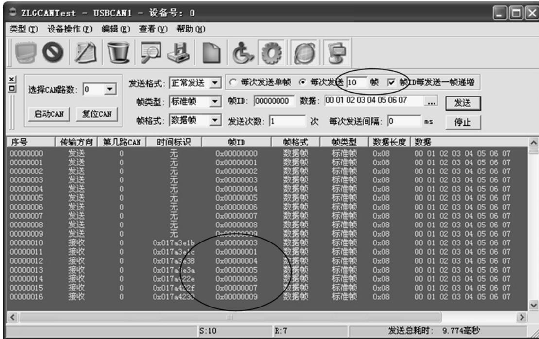
图 1.30 带验收滤波的 CAN 数据收发
