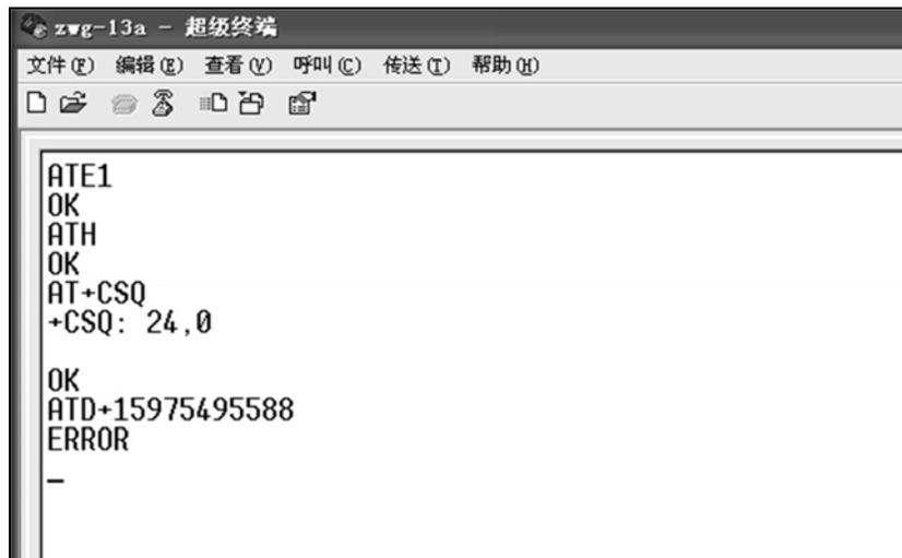
图 1.7 GPRS Modem ZWG-13A 控制
