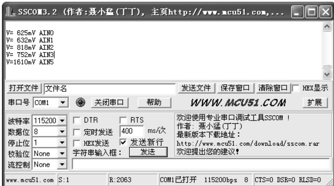
图 1.18 多通道 AD 转换结果
