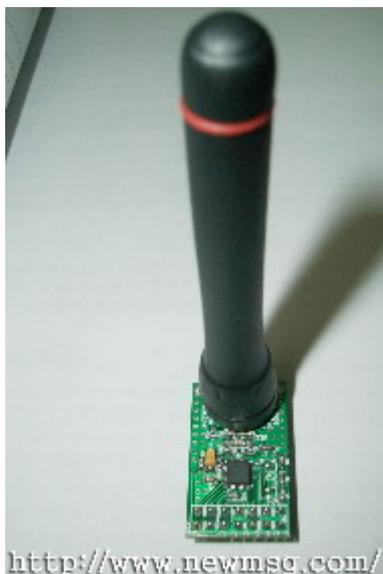
NewMsg\_RF905SE (尺寸: 32mm X 19mm 板厚: 1mm)
