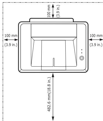
打印操作适合在 1,000 米海拔以下进行。请参考海拔设置以优化打印。将机器放在平坦稳固的平面上，倾斜度不能超过 2 mm。否则可能会影响打印质量。
