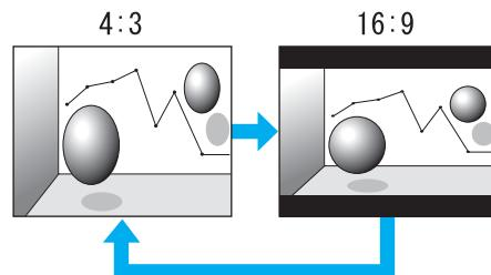
\* 当输入 720p/1080i 信号时，将以缩放的 4:3 格式显示 (左右侧图像被切)。
