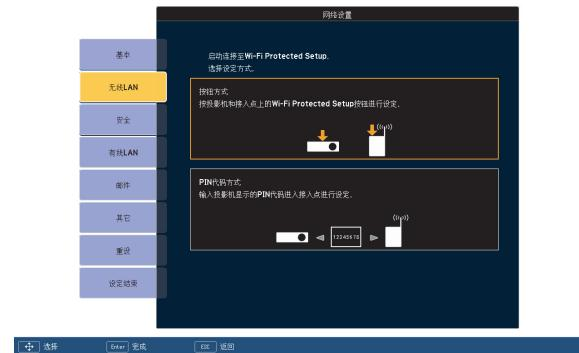
当使用按钮方式连接时，请按照下面提供的步骤操作。要使用PIN代码方式连接
