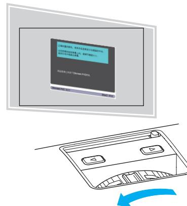
如果即使将变焦环调到最大仍不能使投影区域大于画框，请尝试将投影机移到离屏幕更远的位置。(如果这样做导致信息框移离屏幕中央，请调节它使其再次置中。)
