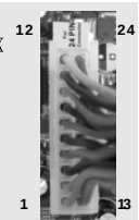
20 ピン ATX 電源装置の取り付け
