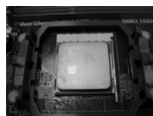
步骤 4： 下推并锁住插座拉杆
