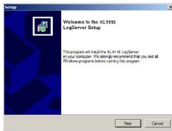
4. 点击**Next**(下一步)。然后按照窗口中的指示完成安装，并将日志服务器程序图标置于您的桌面。
