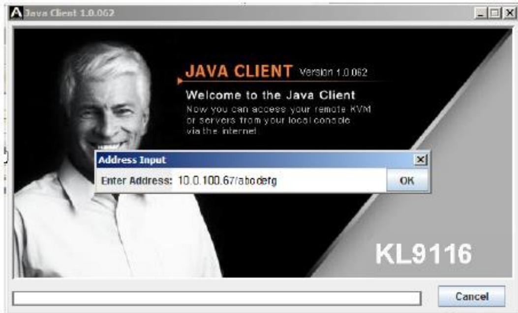
1. 键入您要连接的设备的IP地址 - 包括登录字符串后的斜线(由管理者设置)，然后点击 **OK**。
