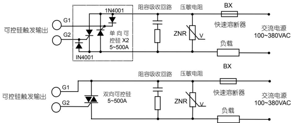
注：1、根据负载的电压及电流大小选择压敏电阻以保护可控硅，负载为感性或采用移相触发时，必须加阻容吸收。2、推荐使用可控硅功率模块，一个功率模块内部包含2个单向可控硅，如图中虚线部分；3、K1/K3/K5触发模块具备“烧不坏”功能，使用方便可靠。4、采用K5型移相触发输出模块时，但交流电源范围缩小为220~380VAC，且电源频率必须为50Hz。
