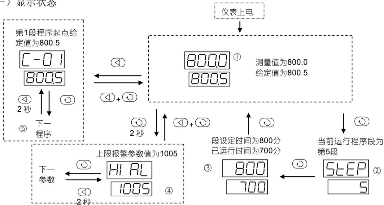
仪表上电后，将进入显示状态①，此时仪表上显示窗口显示测量值（PV），下显示窗口显示给定值（SV）。此为仪表的基本状态，在基本状态下，SV窗口能用交替显示的字符来表示系统某些状态，如下：
