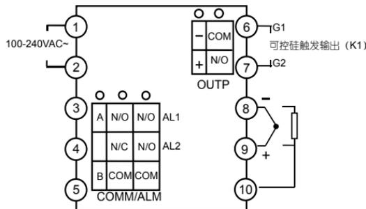
注：本仪表线性电压不支持0~5V及1~5V输入，如有需要应外接精密电阻分压后将信号转换为0-500mV或100-500mV输入。4~20mA线性电流输入用25欧电阻变为100~500mV，然后从9、8端输入。3、4、5端安装S或S4通讯接口模块时用于通讯（COMM），安装L2继电器时用于AL1报警输出。安装L5双继电器输出模块，并将bAud参数设置为0，可用于AL1及AL2报警输出（只具备常开输出端）；安装I2模块，将bAud参数设置为1，则可用于3、5端外接的开关实现SV1/SV2切换（AI-518）或用于控制程序的运行/停止（AI-518P）。
