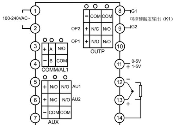
注：线性电压量程在500mV以下的由13、12端输入，0~5V及1~5V的信号由11、12端输入。4~20mA线性电流输入可用250欧电阻变为1~5V电压信号，然后从11、12端输入。COMM位置安装S或S4通讯接口模块时用于通讯，安装继电器/无触点开关/SSR电压输出模块时用于AL1报警输出。
