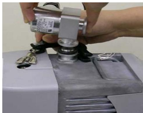
**Figure 9 Vanne d'admission intégrée avec pompe IDP-3**
