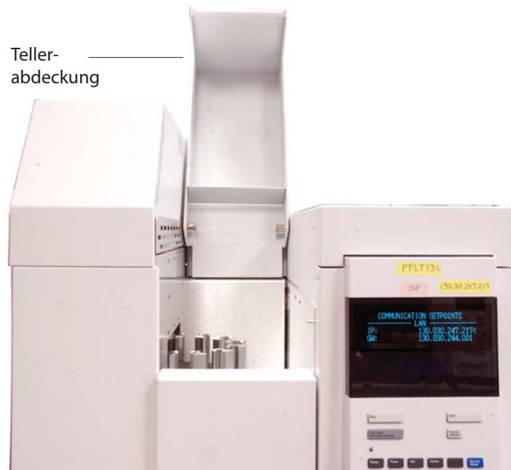
**Abbildung 12** Öffnen Sie die Tellerabdeckung.
