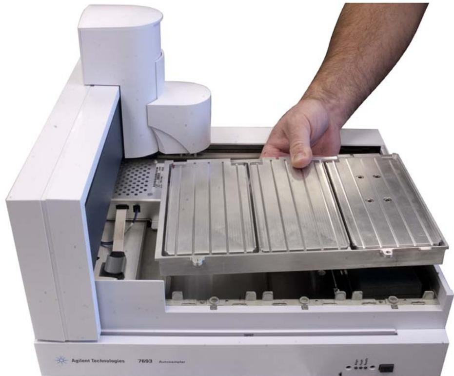
**Abb. 46** Installieren des Peltier-Moduls
