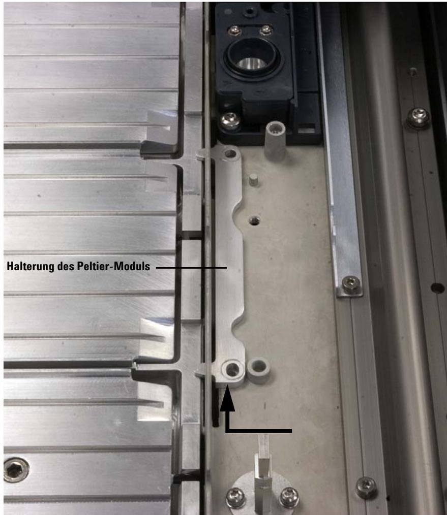
Abb. 49 Installieren der Halterung des Peltier-Moduls
