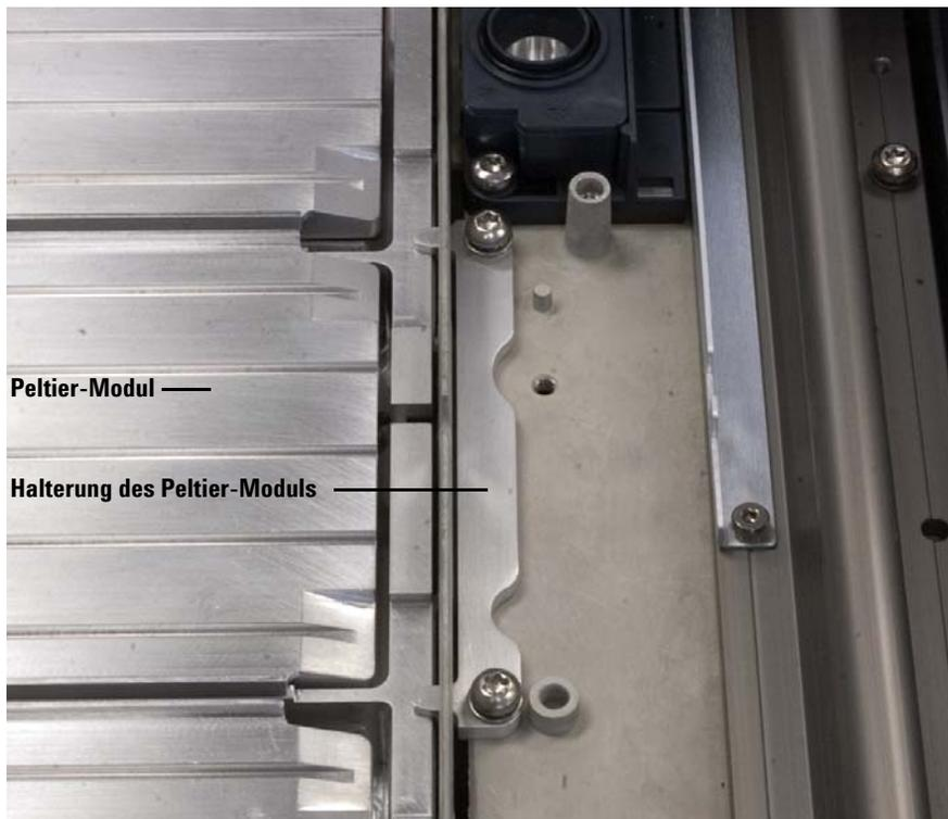
**Abb. 50** Sichern von Peltier-Modul und Halterung des Peltier-Moduls
