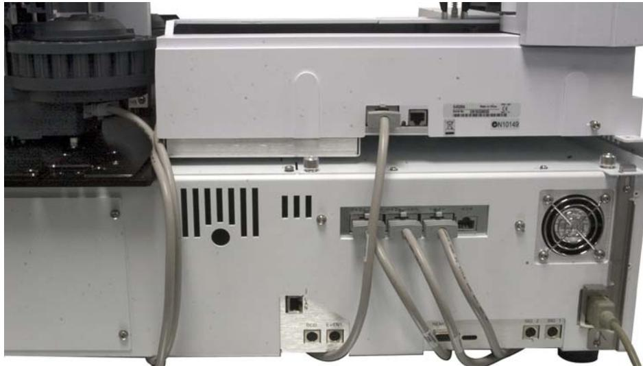
**Abb. 23** Kabelanschluss-Ports
