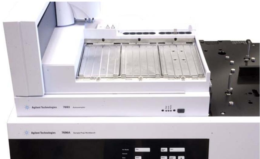
**Abb. 55** Probenteller mit Peltier-Modul liegt gerade auf der Grundplattenoberfläche
