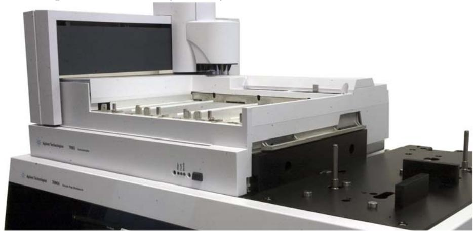
**Abb. 13** Flacher Sitz des Probentellers auf der Grundplattenbasis
