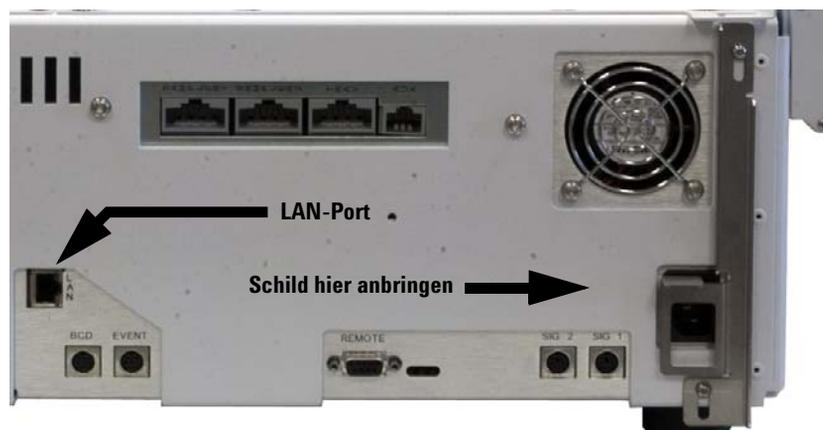
**Abb. 4** Spannungsschild und LAN-Port-Positionen
