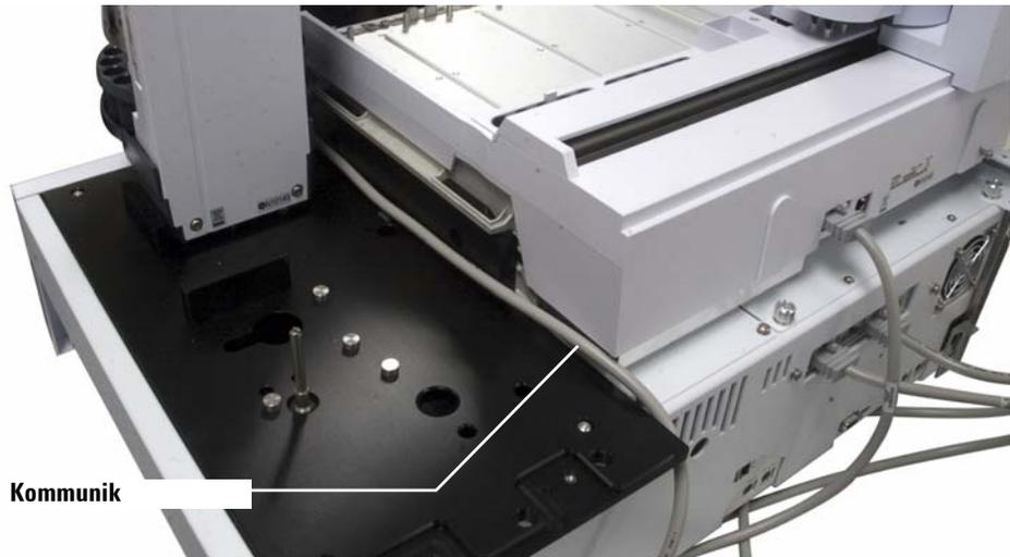
**Abb. 21** Verlegen des Übertragungskabels des vorderen Turms entlang der Halteklammer des Probentellers.
