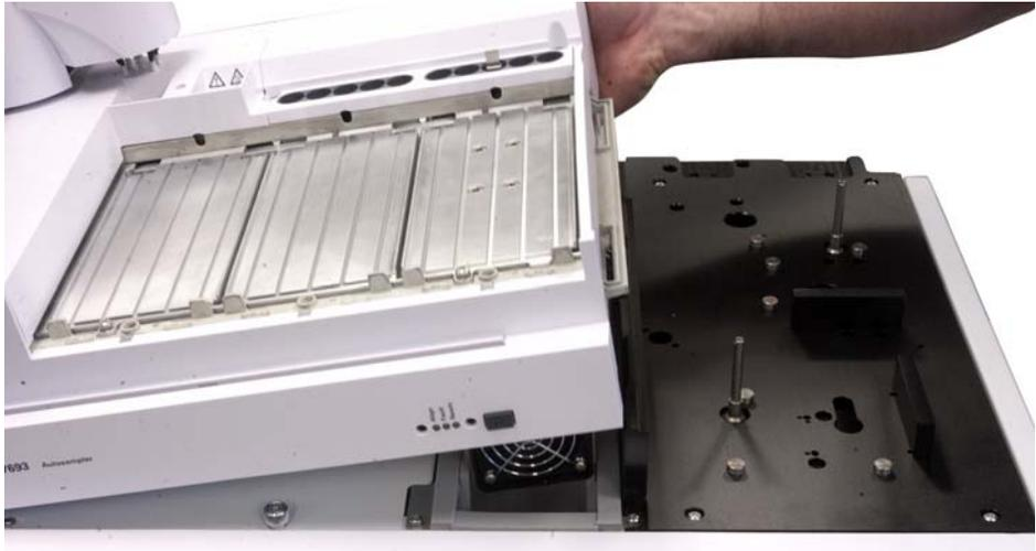
**Abb. 54** Senken des Probentellers auf das Grundplattengehäuse
