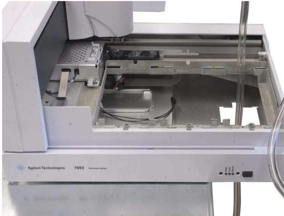
**Abb. 44** Führen der Abflussleitung durch die Zubehöröffnung
