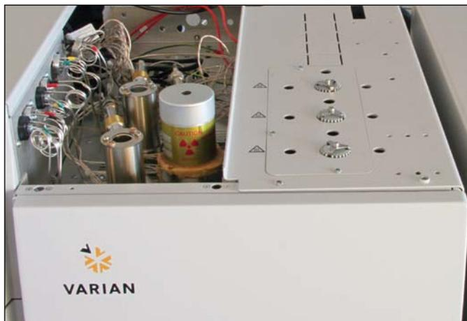
Bis zu drei Detektoren können im 450-GC gleichzeitig installiert werden. Das 220-MS ergibt dann den Detektor Nummer vier!
