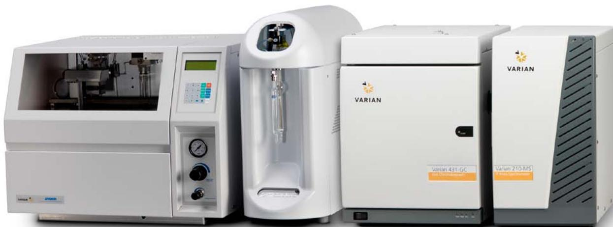
**Boden/Trinkwasser-Analyse.** Zur Messung von flüchtigen organischen Verbindungen (VOC) in Trinkwasser, Abwasser und Bodenproben verwenden Sie am besten den Archon™ Autosampler, den Stratum PTC Purge-and-Trap-Concentrator und den Varian 431-GC mit dem 210-MS.
