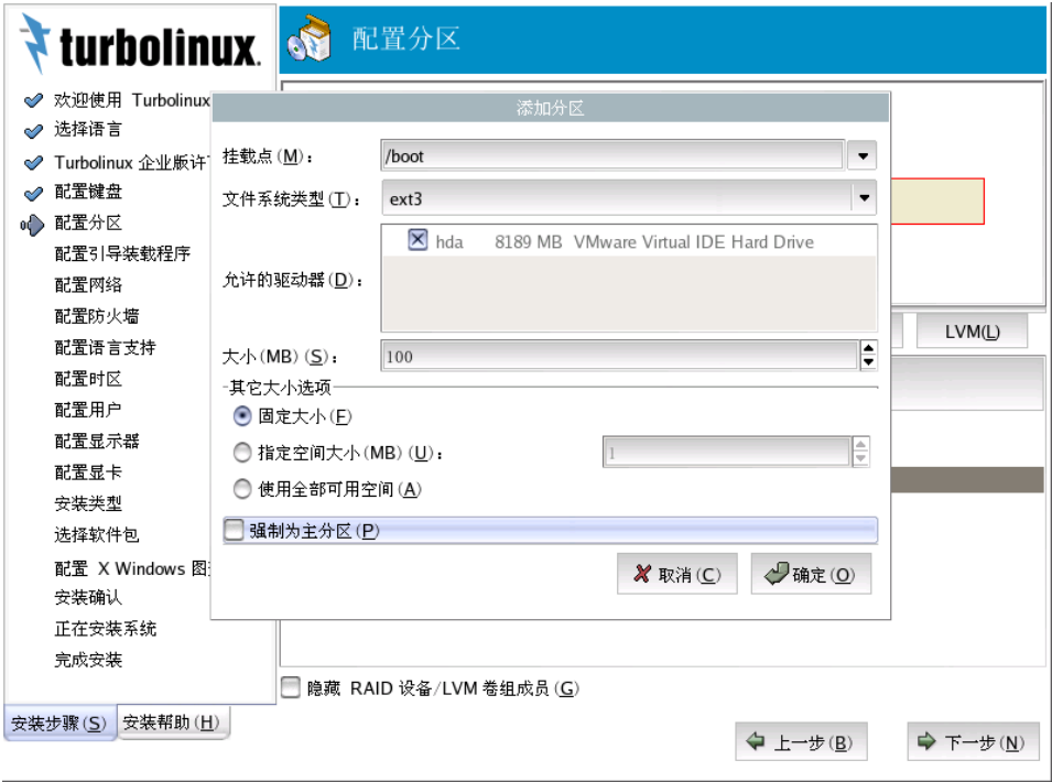
图 3-9 使用 Disk Druid 添加/boot 分区
