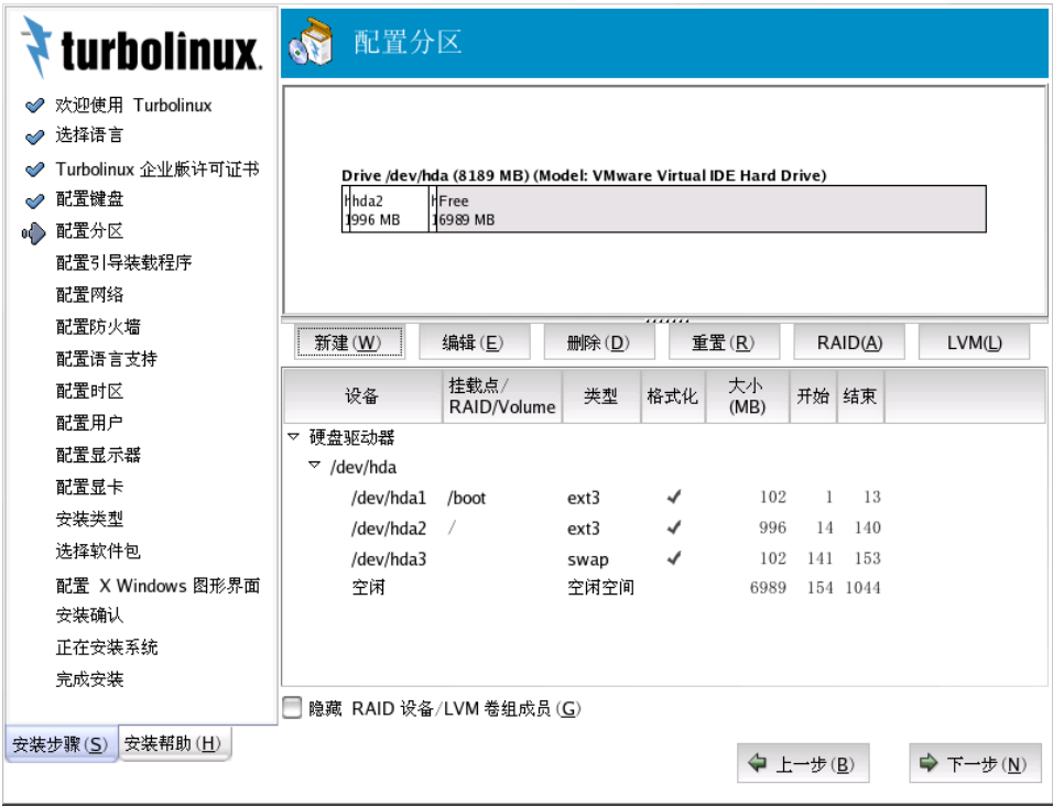
图 3-12 使用 Disk Druid 配置分区后的情况
