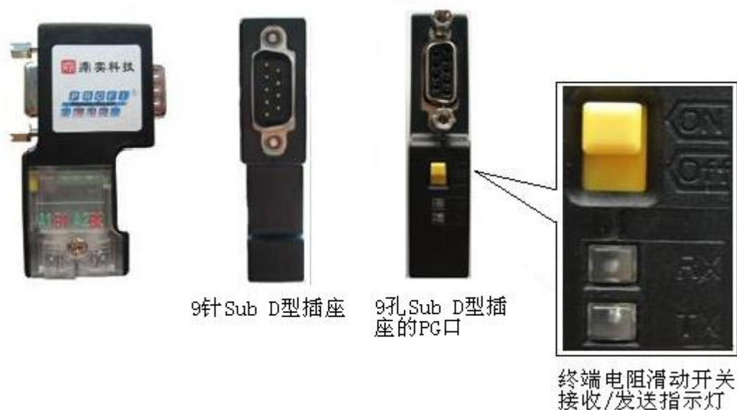
图 2-7 PROFIBUS 总线连接器
