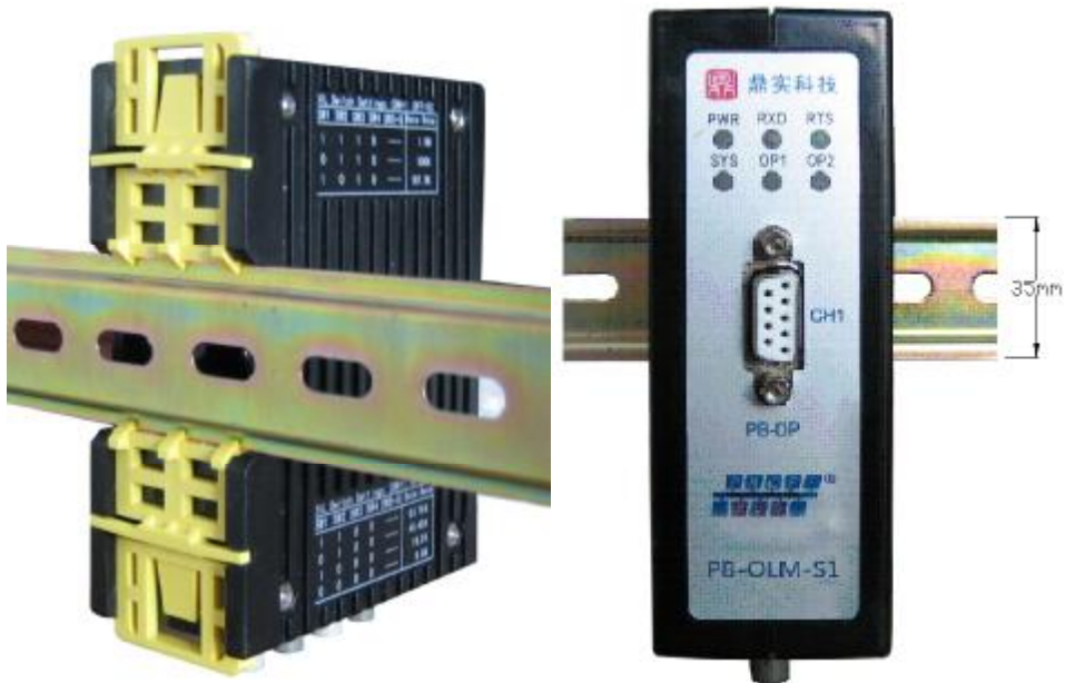
图 2-3 PB-OLM-S1 导轨安装图
