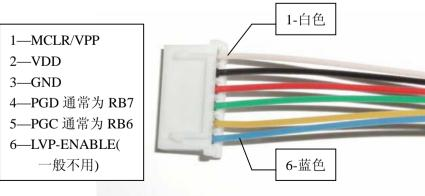
我们使用时只需将 ICSP 各输出线与您要下载的芯片的各引脚——对应连接即可,对于12XXX系列芯片,按照 PGC-GP1, PGD-GP0 的对应关系连接.
