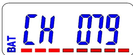
打开电源后，LED 背光灯亮，液晶同时显示当前工作频道及电池电量。若需更改工作频道，应首先改变接收机频道，然后将发射机和接收机上红外对频窗口对准，并按接收机上的“SET”。新的频信道参数就会传至发射机。
