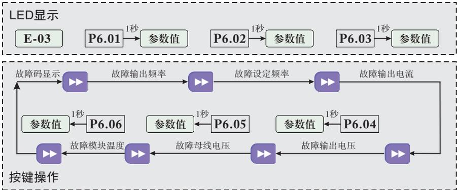
图 4-11 故障状态查询操作示例
