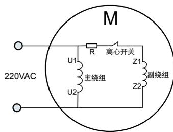
图3-17 电阻启动模式：双电容电机内部接线
