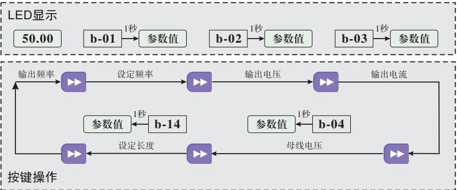
图 4-7 运行状态参数显示操作示例
