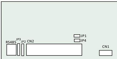
图3-5 控制板端子跳线位置示意图
