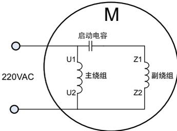
图3-14 运行模式：单电容电机内部接线
