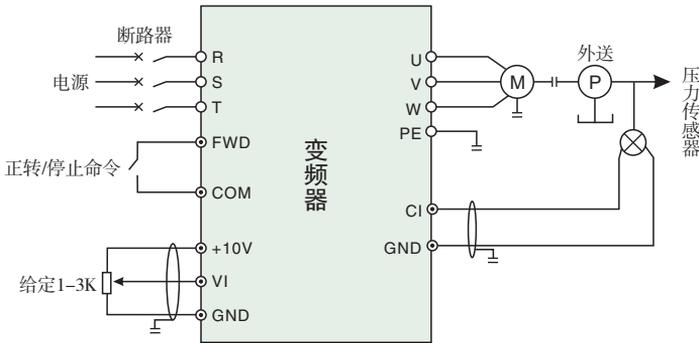
图6-30 内置PI模拟反馈控制系统示意图
