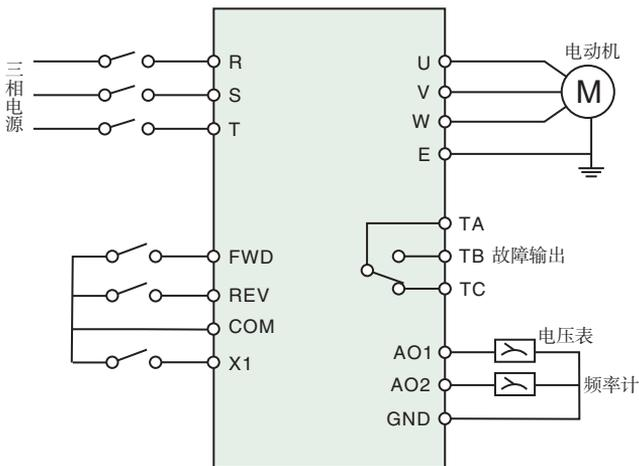
图10-2 三线制控制模式基本接线图
