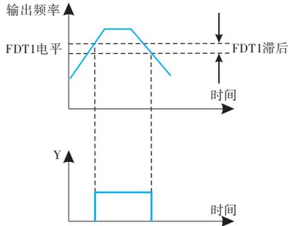
图6-25 频率水平检测示意图
