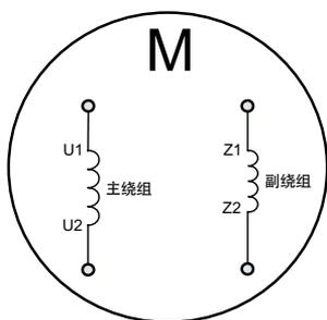
图3-18 电机主副绕组(移除电容后)
