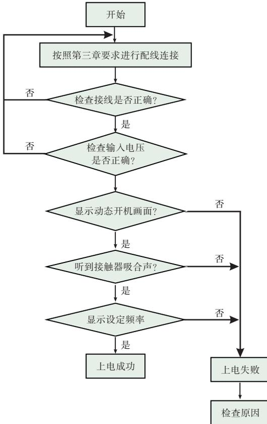
图4-1 变频器初次上电操作流程
