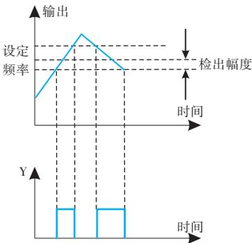
图6-24 频率到达信号输出示意图
