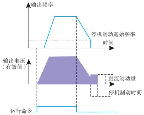
图6-12 减速停车+直流制动示意图
