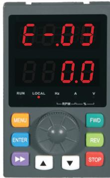
图4-5 故障告警显示状态
