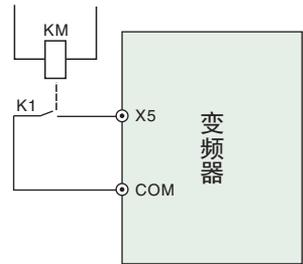
图6-18 外部设备故障输入示意图
