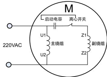
图3-15 启动时模式：单电容电机内部接线
