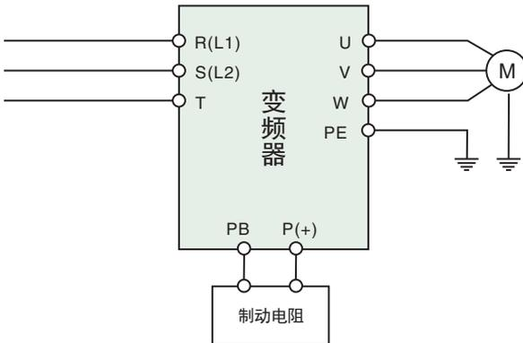
图2-11 变频器与制动组件连线图
