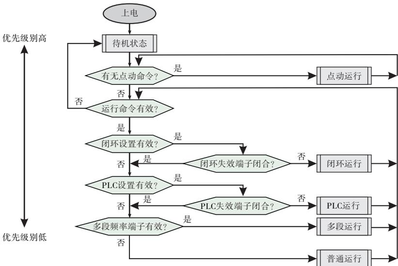
图4-2 变频器运行状态的逻辑关系图
