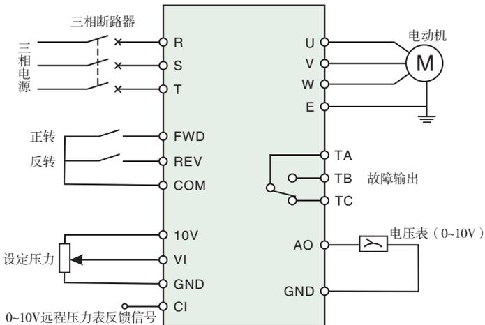
图10-5 变频器构成闭环控制系统接线图
