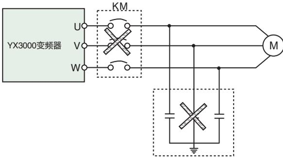
图1-1 变频器输出端禁止使用电容器
