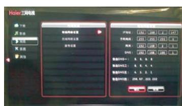
b)手动设置：选择网络设置中的“手动设置”选项，进入手动设置网络地址功能。并在其后的网络地址输入界面中，输入相应的IP地址、子网掩码、网关、DNS服务器等参数，按“确定”按钮完成IP地址设置。
