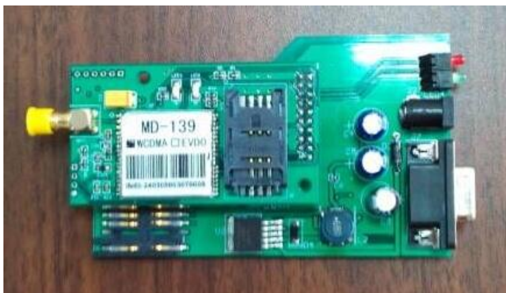
图 2-1: 连接 MD-139 和测试底板
