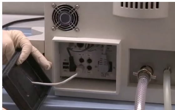
图 5.11: 驱动电机电缆的连接
