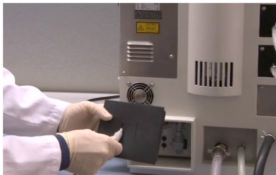
图 5.10: 通过开口引导电缆
