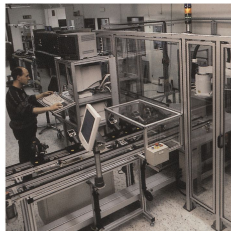
图 23.5 左图：在气候箱中测试红外热像仪；右图：用于热像仪测试和校准的机器人
