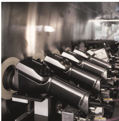
图 23.5 左图：在气候箱中测试红外热像仪；右图：用于热像仪测试和校准的机器人
