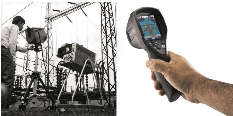
图 23.2 左图：Thermovision 661 型诞生于 1969 年。这款热像仪重量大约在 25 千克（55 磅）左右，示波器重 20 千克（44 磅），三脚架重 15 千克（33 磅）。操作员还需要一个 220 VAC 的发电机组，以及一个装有液氮的 10 升（2.6 美加仑）液罐。在示波器的左边，可以看见 Polaroid 配件（6 千克/13 磅）。右图：Flir i7 诞生于 2012 年。重量为 0.34 千克（0.75 磅）（包括电池）。
