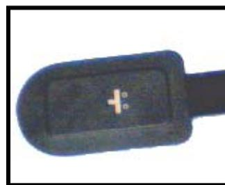
**紧急按钮：**主要用于驾驶员在驾车途中遇到紧急状况时，可以通过该按钮触发 XSE-G05-269 设备向中心平台发出求救信息。通常紧急报警触发按钮安装在驾驶员方便操作且不易被发现的位置。
