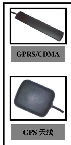
**注意：**GPS 天线在安装过程中尽量保证平面朝上，且 GPS 上方 60 度范围没有金属遮挡物。
