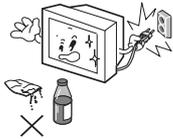
切勿自行拆下电视机后壳，否则您将遭受超高压的电击及其它危险，如果本机工作不正常，请您拨下电源插头并与维修站联系。
