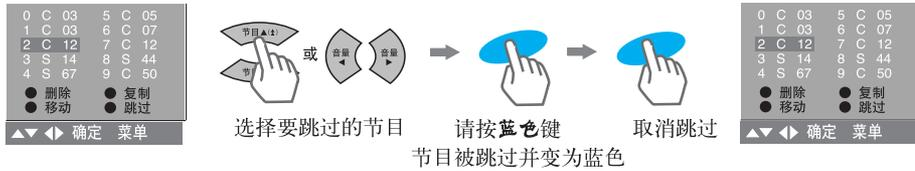
注：在选择节目时，使用▲/▼键无法找到被跳过的节目。如果您想要直接找到被跳过的节目，请使用数字键输入此节目号码，或在频道编辑或节目列表模式下进行选择。
