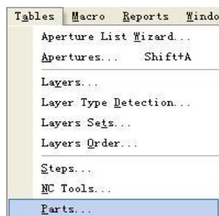
八、点输出列表(Export List)，弹出 Write Centroid Parts 窗口，选择文件输出路径，点击确定。元件信息将输出为后缀.pcf 的文件。
