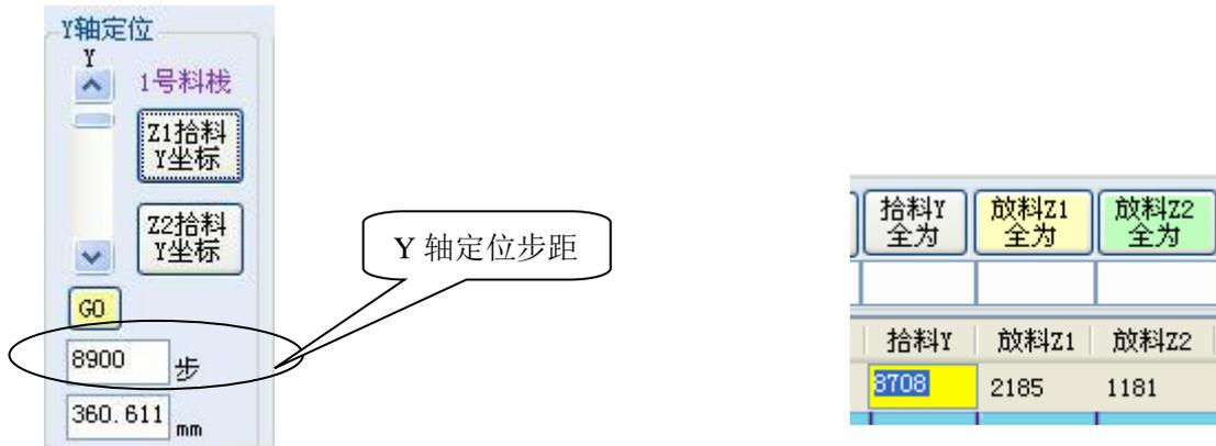
点击 **Z1拾料**，吸嘴下沉至元件，检查吸嘴前后位置是否合适，调整 Y 轴定位步距值，点击 **GO**，直至吸
