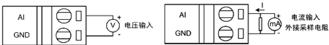
模拟量单端输入接线方式图
