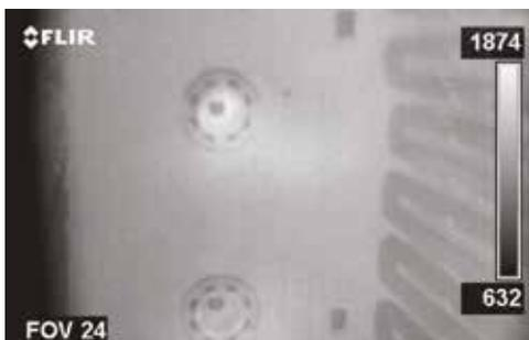
红外图像：FLIR GF309红外热像仪配备了内置火焰滤片，能够穿透火焰执行探测，甚至可测量火焰后方的温度。
