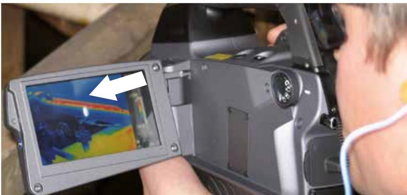
内置液晶屏上实时显示的气体泄漏图像
