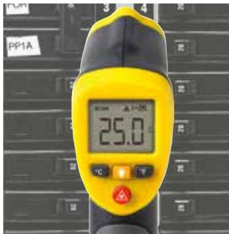
红外测温仪，一个点的温度测量
