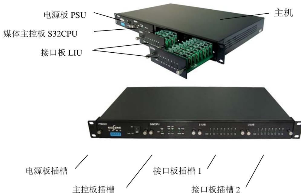
见上图，SAG32 为模块化插板结构，由主机、1 块媒体主控板、1 或 2 块接口板、和 1 块电源板组成。主机有 4 个插槽，从左到右分别是电源板、媒体主控板、接口板插槽 1、接口板插槽 2，接口板插槽可兼容下表各种接口板。媒体主控板可配置容量为 8、16、24、32 路，电源板可选配交流或直流，接口板可最多可配置 2 块，每块容量为 16 路，有多种不同接口类别的组合型号可选。详见下表：
