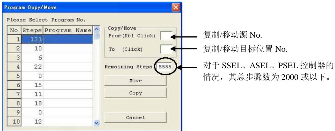
图 5.1 程序的复制/移动
